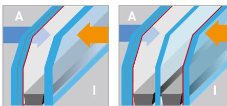
Bei dieser Ausführungsart besteht die äußere wärmeisolierend beschichtete Scheibe aus zwei ca. 4 mm starken aneinandergeklebten Klarglasscheiben mit einem Prüfzeugnis für Durchwurfhemmung.
