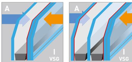
Die innere wärmeisolierend beschichtete Klarglasscheibe wird als Verbundsicherheitsglas ausgeführt. Dabei werden zwei ca. 3 mm starke Klarglasscheiben mit einer hochelastischen Folie aus Polyvinylbutyral (PVB) aneinandergeklebt. Bei Glasbruch haften die Bruchstücke auf der Folie. Somit können sich keine scharfkantigen Glassplitter lösen. Die zähelastische Folie erschwert das Durchdringen durch das Glaselement.
