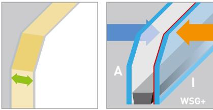
Den Basiswärmeschutz erhalten Sie bei uns bereits ohne Aufpreis. Abhängig zum Glasanteil der gewählten Türfüllung, variiert der rechnerische U-Wert der Füllung ( $U_p$ ) modellbezogen zwischen 0,91 und 1,19°.
